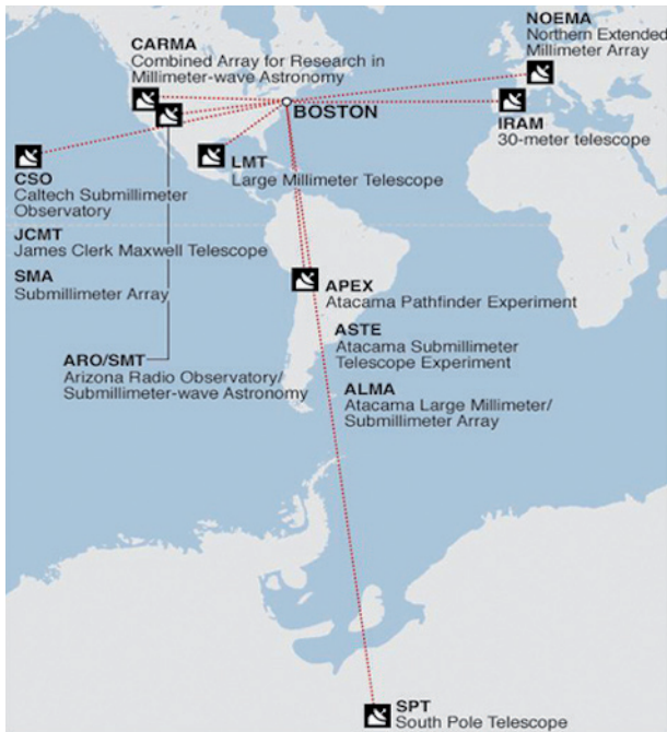
FIG. 5. Rete degli 8 radiotelescopi posti in 4 continenti che costituiscono l'EHT. Operano alla lunghezza d'onda (radio) di 1,3 mm
