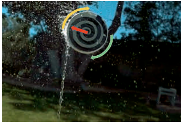
FIG. 13. Disco mantenuto fluttuante ad una certa altezza da un getto d'acqua verticale grazie all'effetto Coandă. Il getto non colpisce il disco alla base ma lateralmente, provocandone la rotazione (freccia verde). L'acqua segue il bordo del disco per un certo tratto, e poi viene scagliata verso destra (freccia gialla). Per reazione il disco spinge verso il getto (freccia rossa) rimanendovi "aderente". Versioni animate di questo esperimento si possono trovare sul web.
